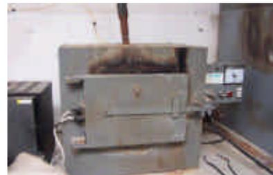
El "árbol" es introducido en el "tarro", de manera que este pueda ser llevado a un vacum donde se succiona el oxígeno para evitar porosidad en la pieza, luego de un proceso en el que es cubierto con yeso de revestimiento. Luego es introducido en el horno; el tiempo y la temperatura del horno dependerán del tamaño del tarro.
