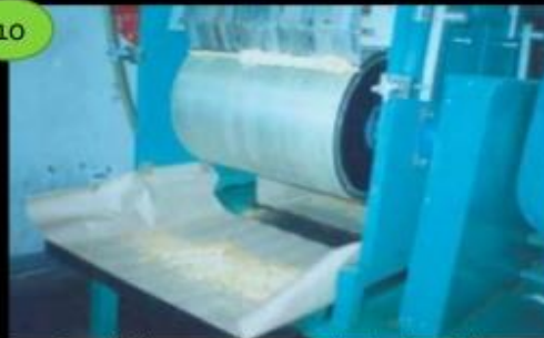
Deshidratación y gelatinización en secador de tambor
